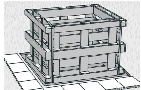
4. Damit keine Erde aus den Zwischenräumen der Paletten rieseln kann, wird innen eine Noppenfolie angebracht. Tacker die Noppenfolie auf den Boden des Hochbeets und schneide mit einem Stanleymesser einige Schlitze hinein – so kann das Wasser später abfließen. Dann lege die Folie ohne Spannung an die inneren Seitenwände des Hochbeets und tacker sie fest. Jetzt kann das Hochbeet befüllt und bepflanzt werden.
