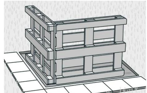
2. Die Paletten werden an den Rändern der Bretter verschraubt, deshalb solltest du sie vorbohren. Richte die Paletten an den Ecken bündig aus. Die Schrauben werden später zwischen den Fußteilen in die Stirnseite der anliegenden Bretter geschraubt. Markiere die Bohrlöcher und bohre die Bretter vor. Verschraube sie anschließend mit Senkkopf-Holzschrauben.
